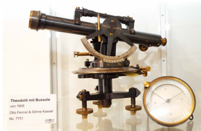
Einer der drei ausgestellten Theodoliten – dieses Exemplar ist zusätzlich mit einer Bussole ausgestattet.
